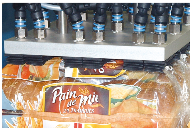
Сильфонные присоски FSGB-R, используемые для перемещения упаковочных материалов
